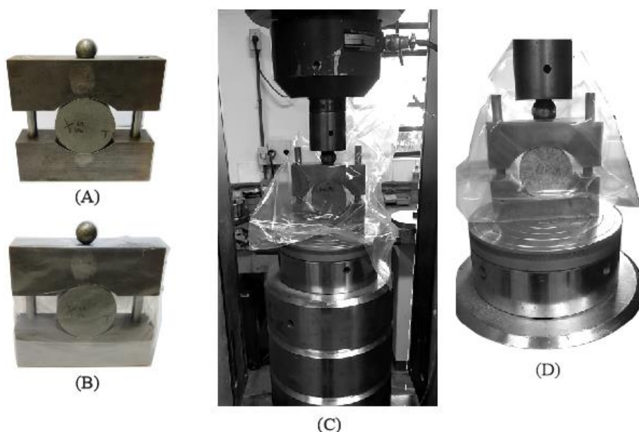
Figura 2. (A) Aparato do ensaio de compressão diametral com corpo de prova, (B) Envelopamento do equipamento para controle dos finos, (C) Configuração de ensaio em prensa servo controlada do Laboratório de Mecânica das Rochas do Depto. de Geotecnia da EESC/USP e (D) Detalhe da foto anterior.
