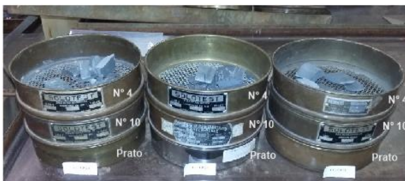
Figura 3. Jogo de peneiras utilizadas para peneiramento com material após ensaio.
